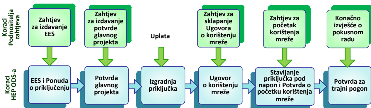
Slika 4. Prikaz koraka pri jednostavnom priključenju na distribucijsku mrežu ako je u EES uvjetovan pokusni rad
